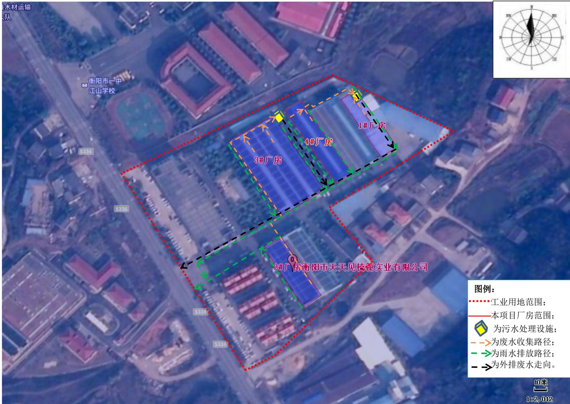
附图 3：厂区雨污分流管网图
