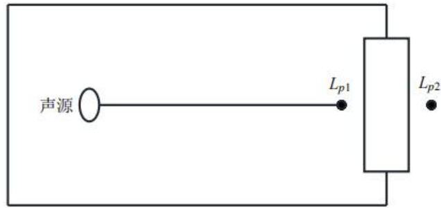
图 4-1 室内声源等效为室外声源图例
