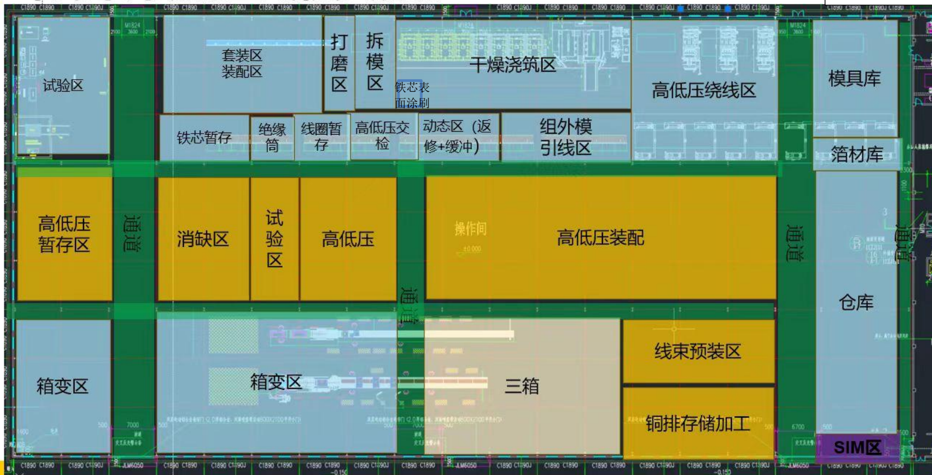
附图3-2: 1#厂房内部平面布置初步规划图
